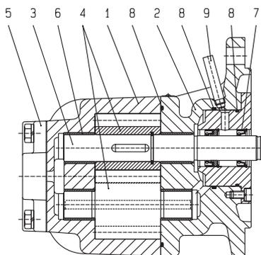
Abb. 4 **Pumpe ohne Vorsatzlager, Sondernummer 309 (Vakuumausführung)**
