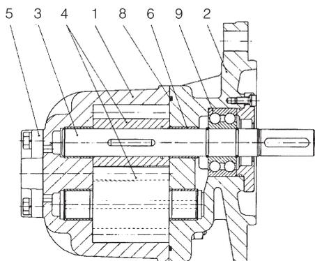
Abb. 3 **Pumpe mit Vorsatzlager, Sondernummer 196 (ohne Wellendichtring)**
