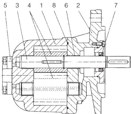
Abb. 2 **Pumpe ohne Vorsatzlager, Sondernummer 197 (mit Wellendichtring)**
