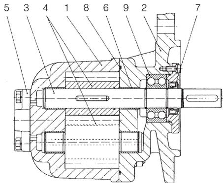
Abb. 1 **Pumpe mit Vorsatzlager, Sondernummer 197 (mit Wellendichtring)**
